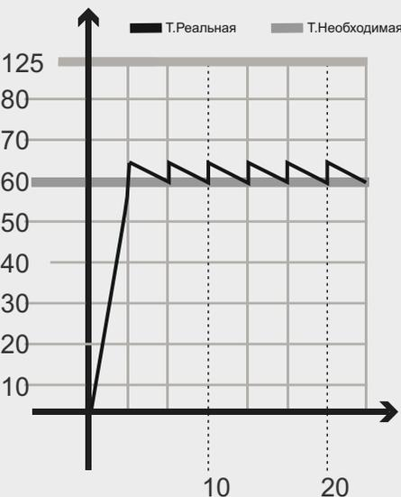
График работы терморегулятора с подключенным регулятором мощности. Терморегулятор отслеживая температуру и регулируя её с помощью РН позволяет добиться максимально необходимых значений температур (в пределах выполняемой программы).
